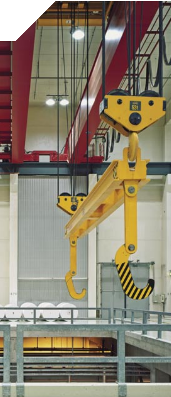
Vasen kuva: Konecranesin prosessintuoturi M-Realin Kirkniemen paperitehtaalla Oikea kuva: Konecranesin kumipyöräkonttintuotureita, APM Terminals, Los Angeles, USA
